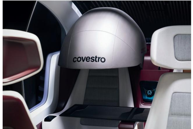
**Bild 4.** Beim PrivacyDome, einer herausfahrbaren Kuppel, sorgt das PUR-System Baynat von Covestro für eine wirkungsvolle Schalldämpfung. Bei Elektrofahrzeugen und autonom fahrenden Automobilen spielt die Geräuschminderung eine sehr wichtige Rolle © Covestro
